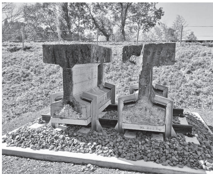
写真－2 本体と同じ配合・寸法・環境に暴露した標準桁
